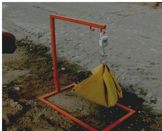
Ważenie tacki pomiarowej ze spoiwem
